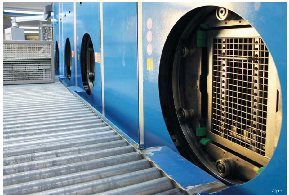
In Cofra l'inserimento dei cesti nell'impianto avviene in modo manuale tramite operatore.
