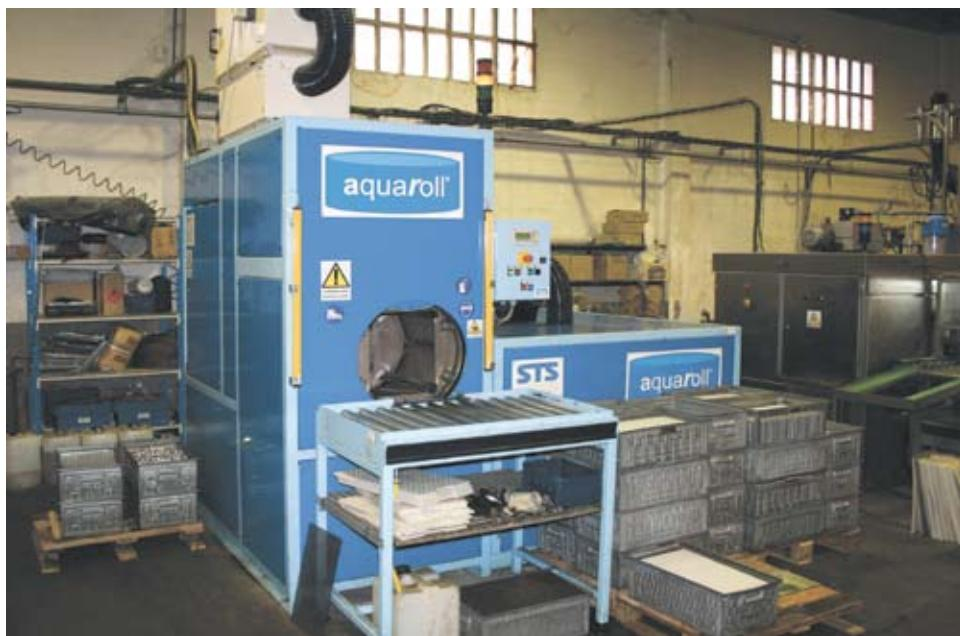
6 – Un'altra vista della macchina della Sts. Lava, risciacqua e asciuga i pezzi contenuti in 2 cestelli contemporaneamente. A destra si vede un'altra macchina dedicata al lavaggio interoperazionale, la prima installata da BVentura a sostituire una fase solvente con una detergente.
