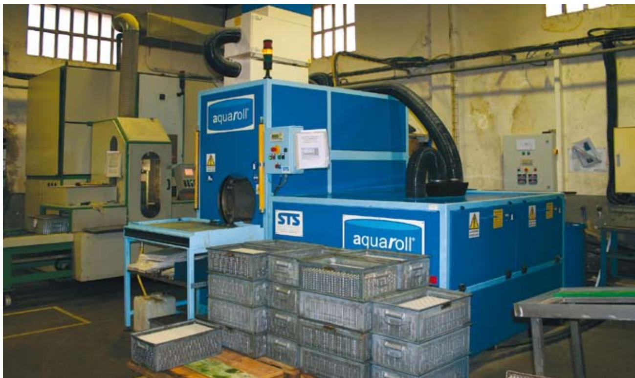
**5 – Una vista della macchina installata da Sts nello stabilimento della BVentura, operante con sistemi a base acquosa. Effettua un ciclo combinato, con cesti in rotazione, a spruzzo/immersione/idrocinetico, doppio risciacquo, asciugatura ad aria calda/vuoto. Sostituisce una delle macchine a percloro preesistenti (una è visibile dietro alla nuova macchina a base acquosa).**
