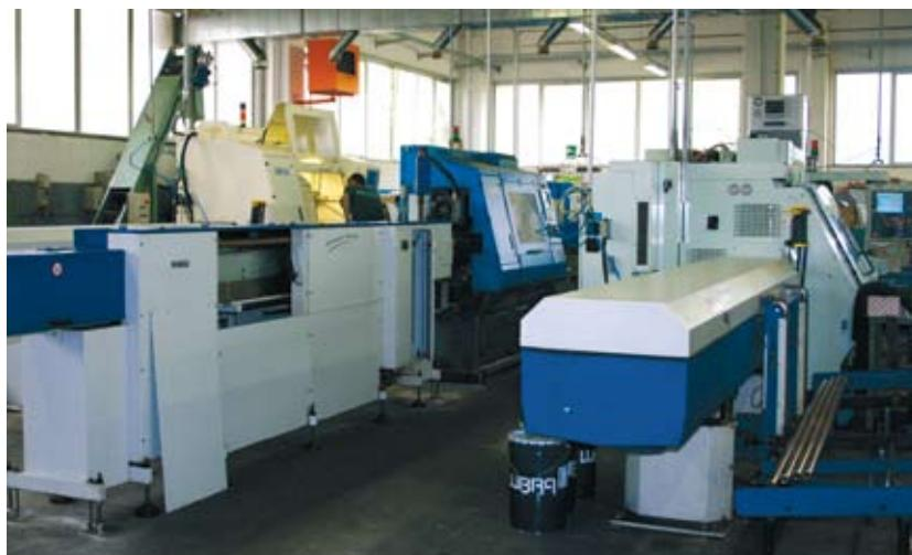
6 – Alcune delle macchine di lavorazione dei pezzi. I contaminanti maggiori sono proprio i residui da lavorazione, come barbe e trucioli misti ad oli di lavorazione.
