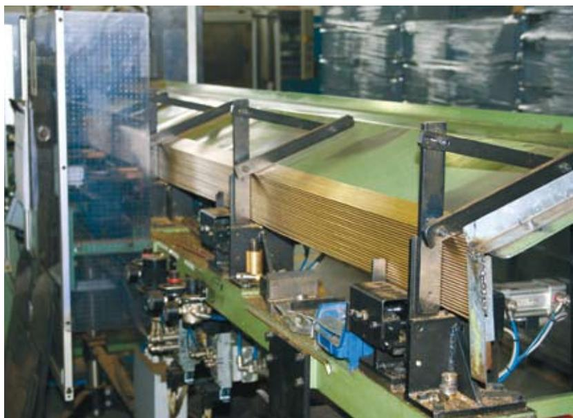
4 – Tondini di ottone già posizionati su una delle macchine di prima lavorazione.
