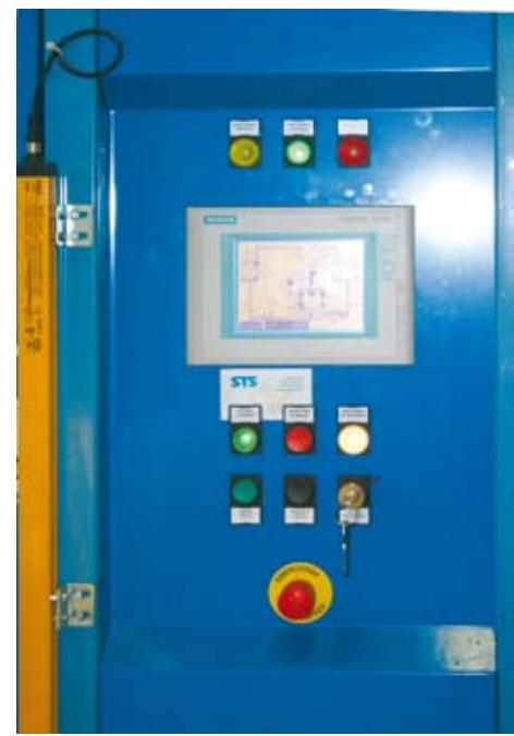
**8 – Il pannello di programmazione dei processi di lavaggio.**
