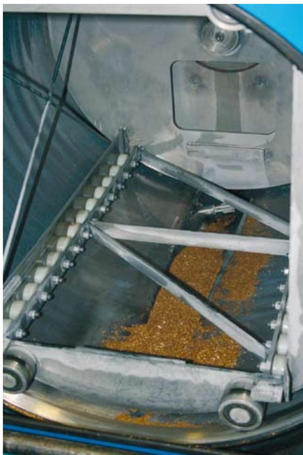
9 – I residui metallici al termine delle operazioni di lavaggio.
