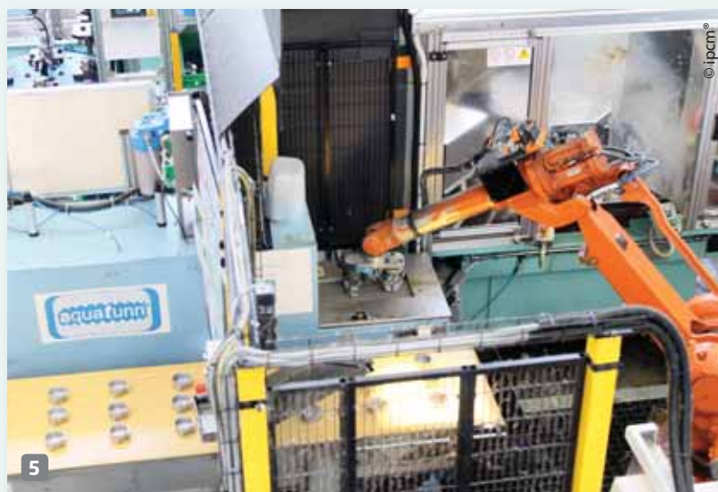
5 The robot places the parts to be cleaned on the conveyor belt of Aquatunn®: Sepam is characterised by the high automation degree of its production cycle, perfectly integrated with the manual operations of the workers along the line. Il robot antropomorfo posiziona i pezzi da lavare sul nastro trasportatore di Aquatunn®: Sepam si caratterizza per l'elevato grado di automazione della produzione perfettamente integrato con le operazioni manuali degli operai presenti lungo la linea.
