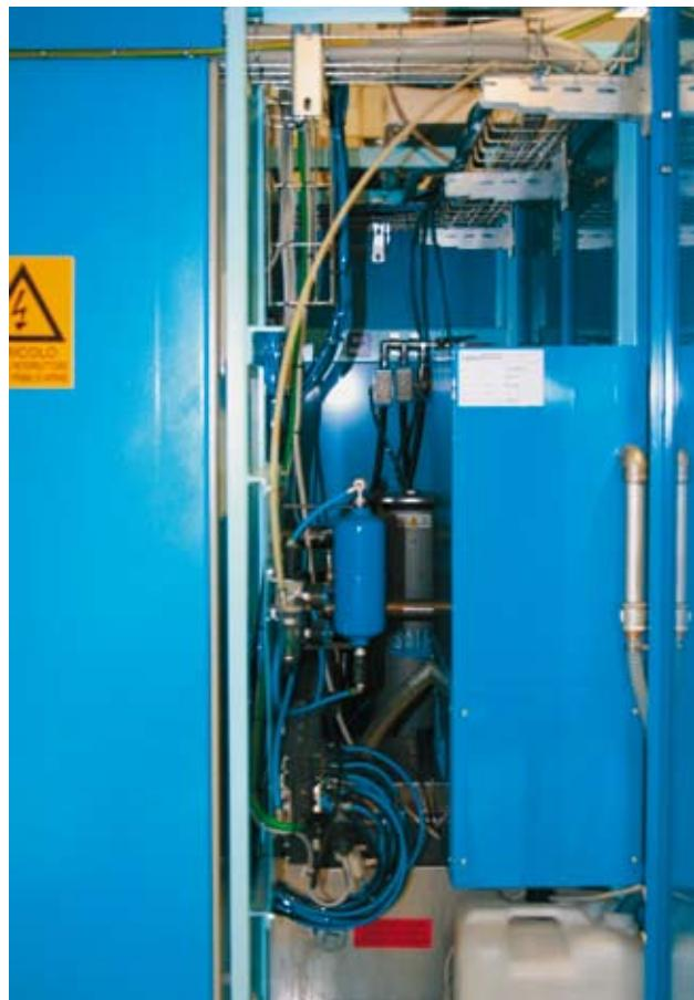
7 – La máquina está dotada de un desaceitador interno.
